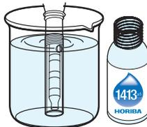
3. Premere il pulsante CAL sul misuratore per passare alla modalità di calibrazione.
